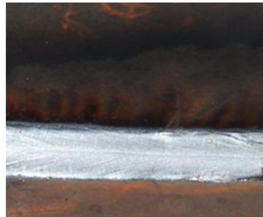
S355, t=10 mm, T-Stoß, Kehlnaht ohne Schweißnahtvorbereitung
