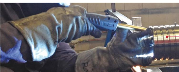
**Schweißen im Inneren von Rohren mit extra langem Brennerhals und kleinem Biegeradius**
