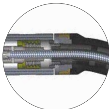
Monoblockdüse: doppelte Düsensitzisolation mit Glasgewebe und PTFE
